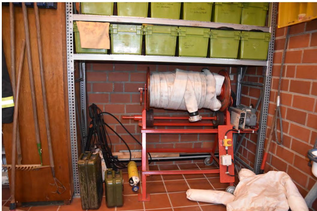
Abb. 7.3-39: OF Kettenkamp: Werkstatt mit elektrischer Aufrollhilfe für Schlauchhaspeln
