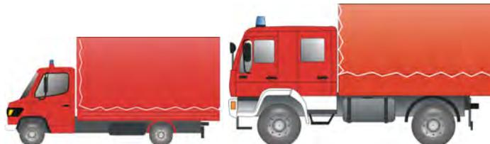
Fahrzeug für den Materialtransport, häufig in Ausführung als Kleintransporter mit Pritsche (ggf. mit Plane und Spiegel) oder als Lkw mit Kastenaufbau, wobei der GW-L2 den bisherigen Schlauchwagen SW 2000 ersetzt.
