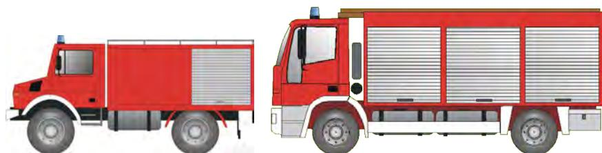
Feuerwehrfahrzeug mit großem Wasservorrat und Beladung für die Brandbekämpfung. Tanklöschfahrzeuge werden nach Norm über die Leistung der Feuerlöschkreiselpumpe und die Größe des Wasservorrats benannt:
