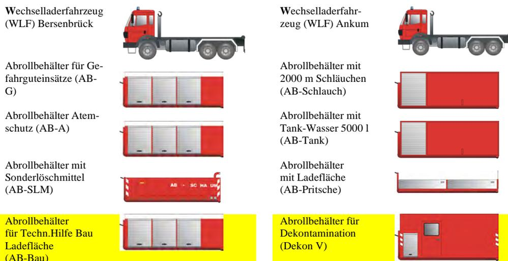
Abb. 8.3-2: Fahrzeuge und Abrollbehälter (gelb hinterlegt: weitere Einsatzmöglichkeiten)
