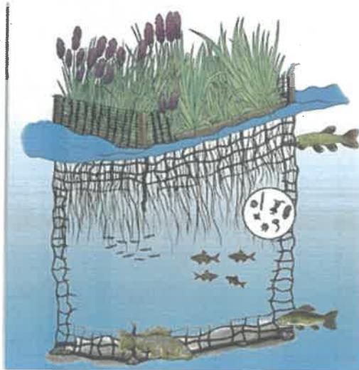
Bei der Netzlänge muss die Wasserschwankung immer berücksichtigt werden. Das Geflecht muss grundsätzlich auf dem Gewässergrund aufliegen, damit keine Tiere von unten hineintauchen können. Aus diesem Grund wird das Geflecht mit einer Kette aus Edelstahl beschwert, die auf den Gewässergrund aufliegt. Eine zweite Edelstahlkette, zur Spannung des Unterwasserschutzgeflechts, wird ca. 1 m über den Gewässergrund eingearbeitet.
