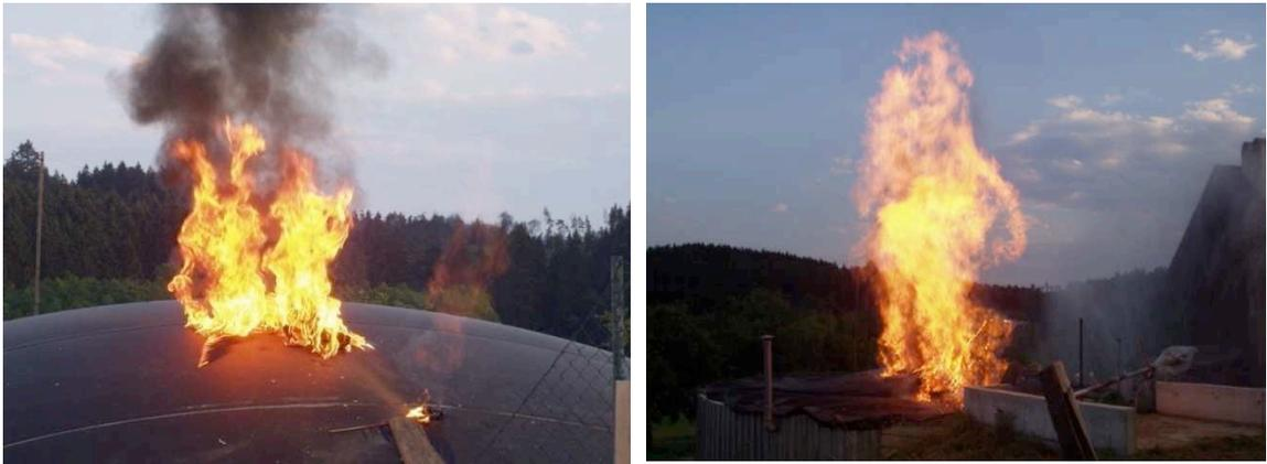
Abb.: Brandversuch an einer EPDM-Folie
