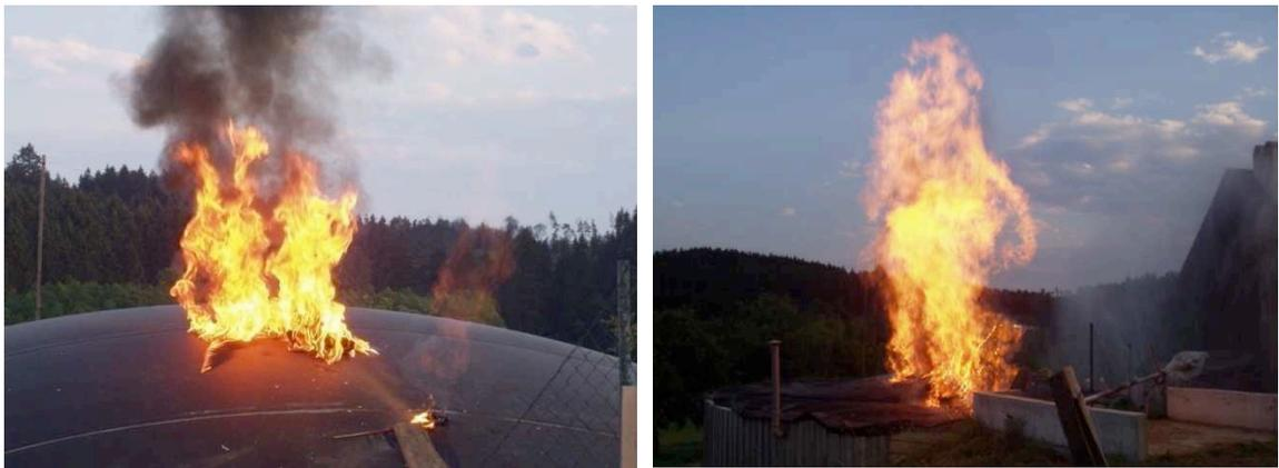
Abb.: Brandversuch an einer EPDM-Folie
